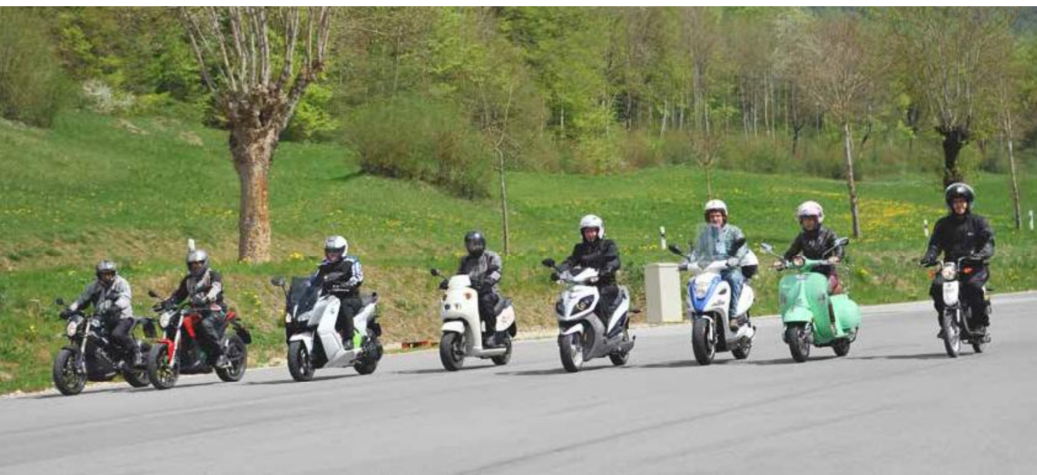
Die Testflotte von links nach rechts: Brammo Empulse R (v-max 177 km/h), Zero SR (164 km/h), BMW C Evolution (120 km/h), VR-one (100 km/h), Emco Novum S 5000 (82 km/h), Etrix S4 (45 km/h), Emco Nova R 2000 (45 km/h), Yamaha EC-03 (45 km/h).
